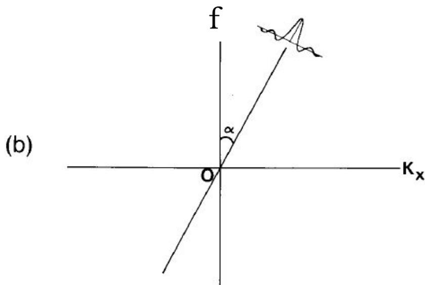
Сигналы с одним и тем же наклоном в пространстве  $(t, x)$  независимо от их положения попадают на одну радиальную линию в пространстве  $(f, k)$ .
