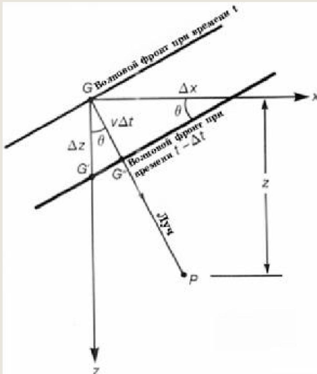
Геометрические построения для экстраполяции волнового поля (Yilmaz)
