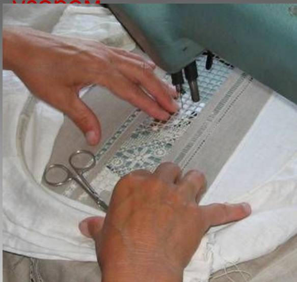
Закрепление сетки и машинная вышивка. Цех ЗАО «Гипюр»
