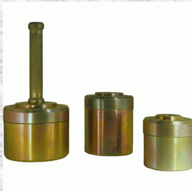
Специальные металлические цилиндры для измерения объемной массы почвы
