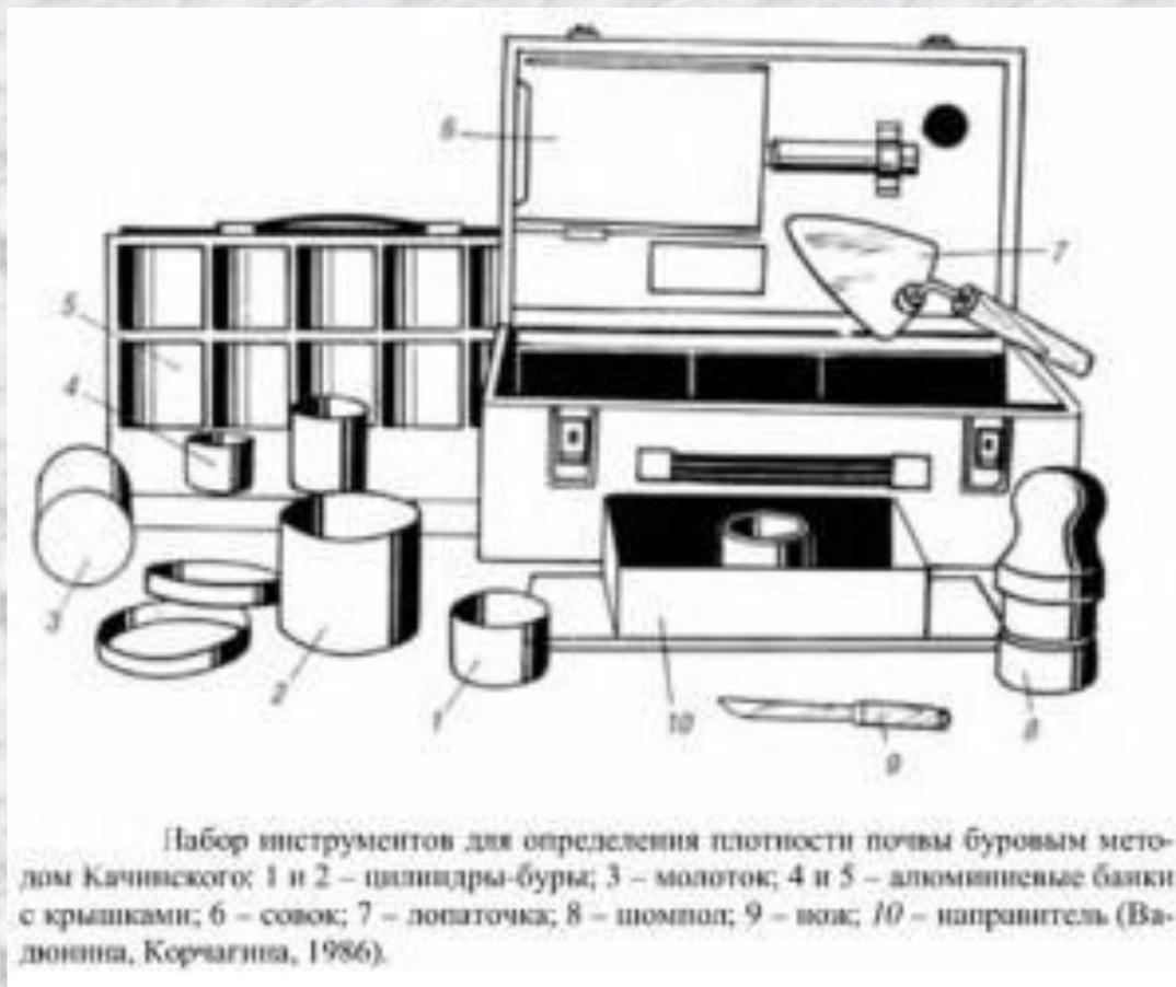
Набор инструментов для определения плотности почвы буровым методом Качиньского: 1 и 2 – цилиндры-буры; 3 – молоток; 4 и 5 – алюминиевые банки с крышками; 6 – совок; 7 – лопаточка; 8 – шомпол; 9 – нож; 10 – напранитель (Вадюшина, Корчагина, 1986).
