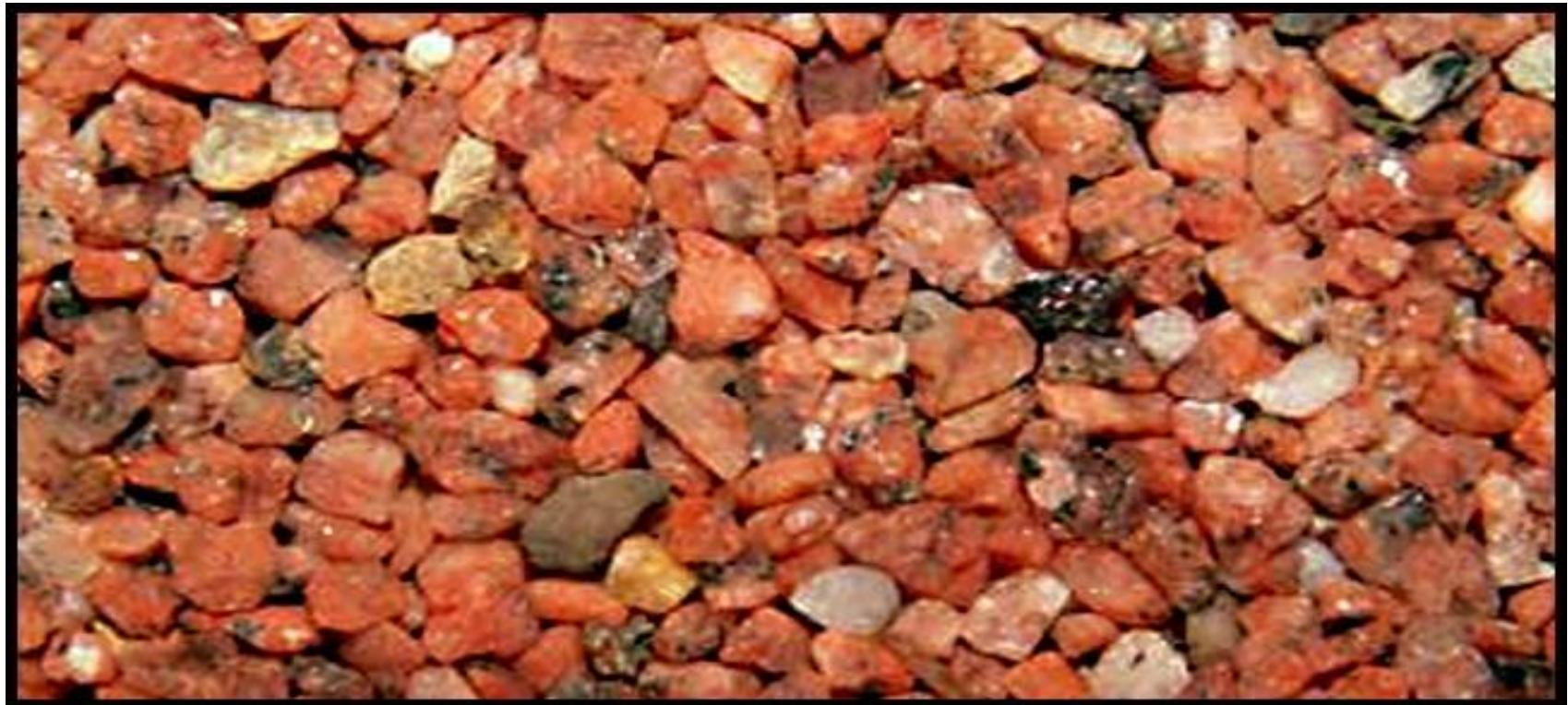
**Осадочные породы** содержат кварц, полевой шпат, слюды, а также экзогенные минералы – каолинит, монтмориллонит, гипс и др. Известняк, доломит, мергель содержат карбонатные и сульфатные минералы.
