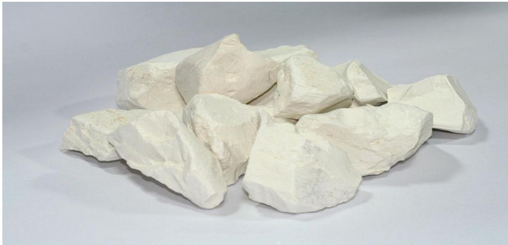
Плотность частиц глинистых минералов колеблется от 1,77 до 2,60 г/см<sup>3</sup> и выше для монтмориллонита и слюд.
