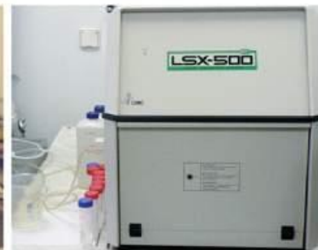
Лазерная абляция проб
