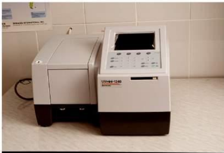
Оптический спектрометр UV1240
