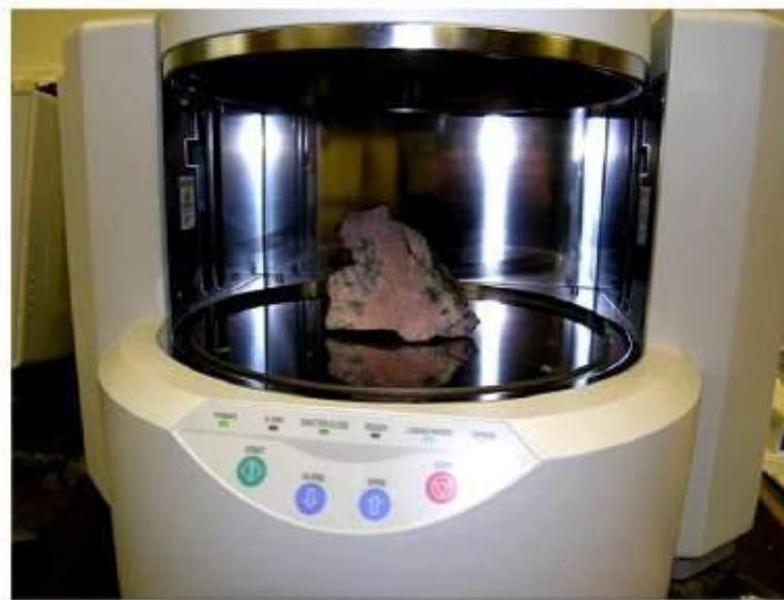
Камера спектрометра EDX-900HS с образцом
