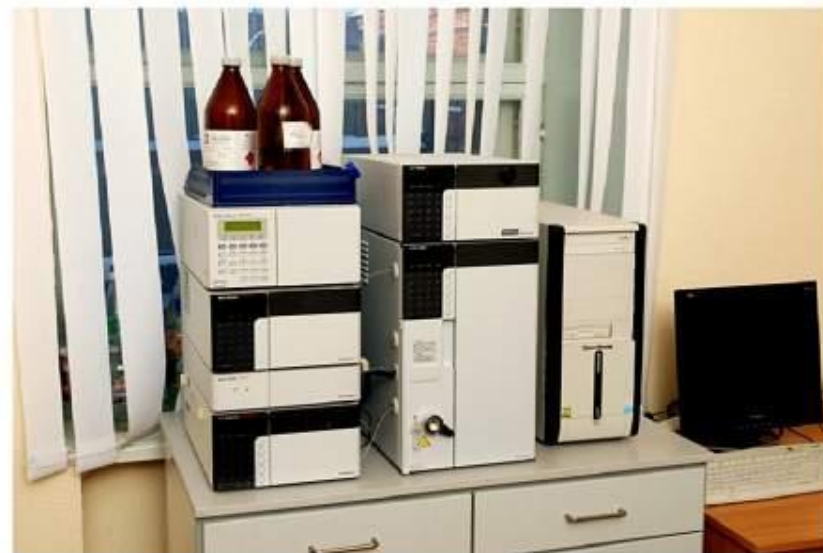
Газовый и жидкостный хроматографы GC-2010 и LC-2010
