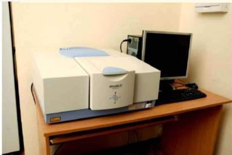
ИК-Фурье спектрометр IR Prestige 21
