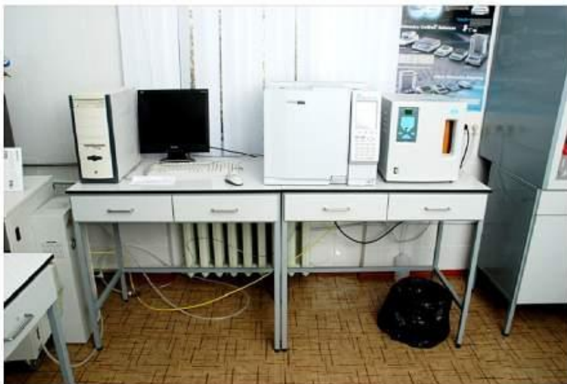
Газовый и жидкостный хроматографы GC-2010 и LC-2010
