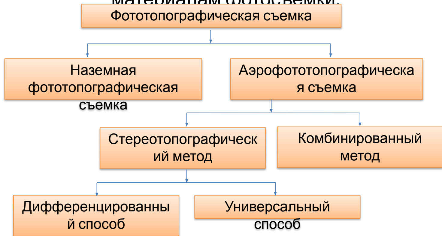
Рисунок 20 - Фотограмметрические методы, применяемые для создания планов и карт
