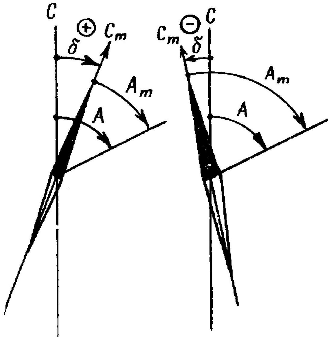
*Дирекционный угол* – это угол между северным направлением осевого меридиана или параллельной ему линии и определяется направлением, отсчитывается по часовой стрелке от  $0^\circ$  до  $360^\circ$ .
