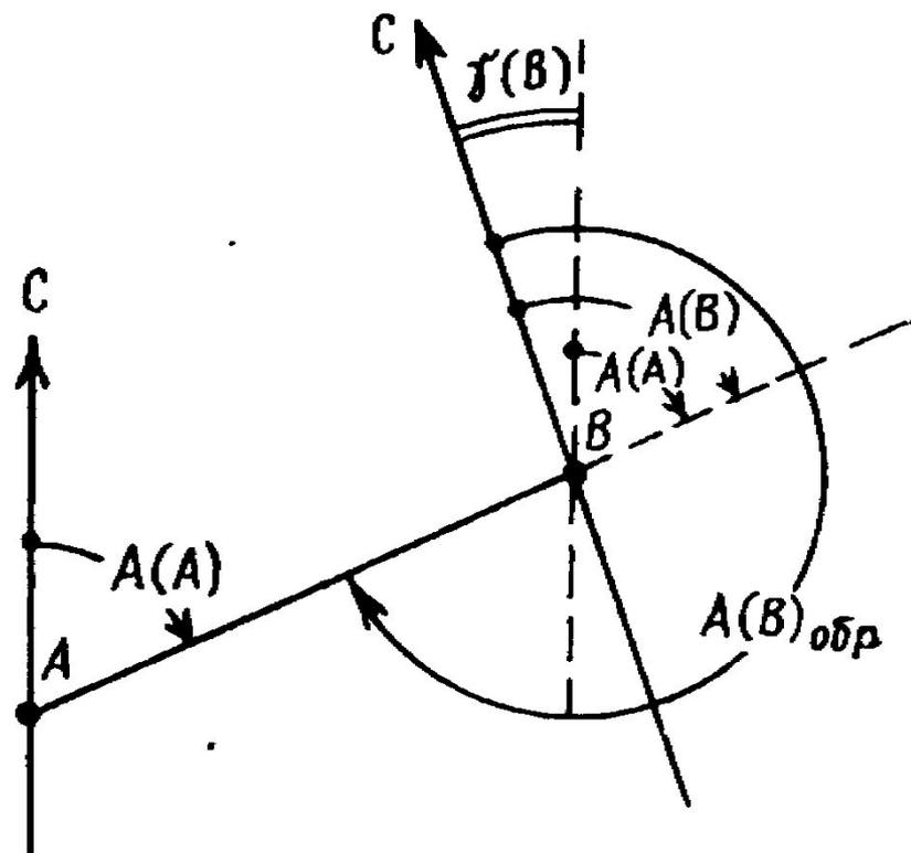
Географические меридианы в разных точках сфероида не параллельны между собой, поэтому азимут одной и той же линии (линия 1–2) в различных ее точках будет различен.
