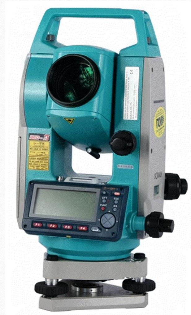
Большинство современных тахеометров оборудованы вычислительным и запоминающим устройствами, позволяющими сохранять измеренные или проектные данные, вычислять координаты точек, недоступных для прямых измерений, по косвенным наблюдениям, и т. д. Некоторые современные модели дополнительно оснащены
