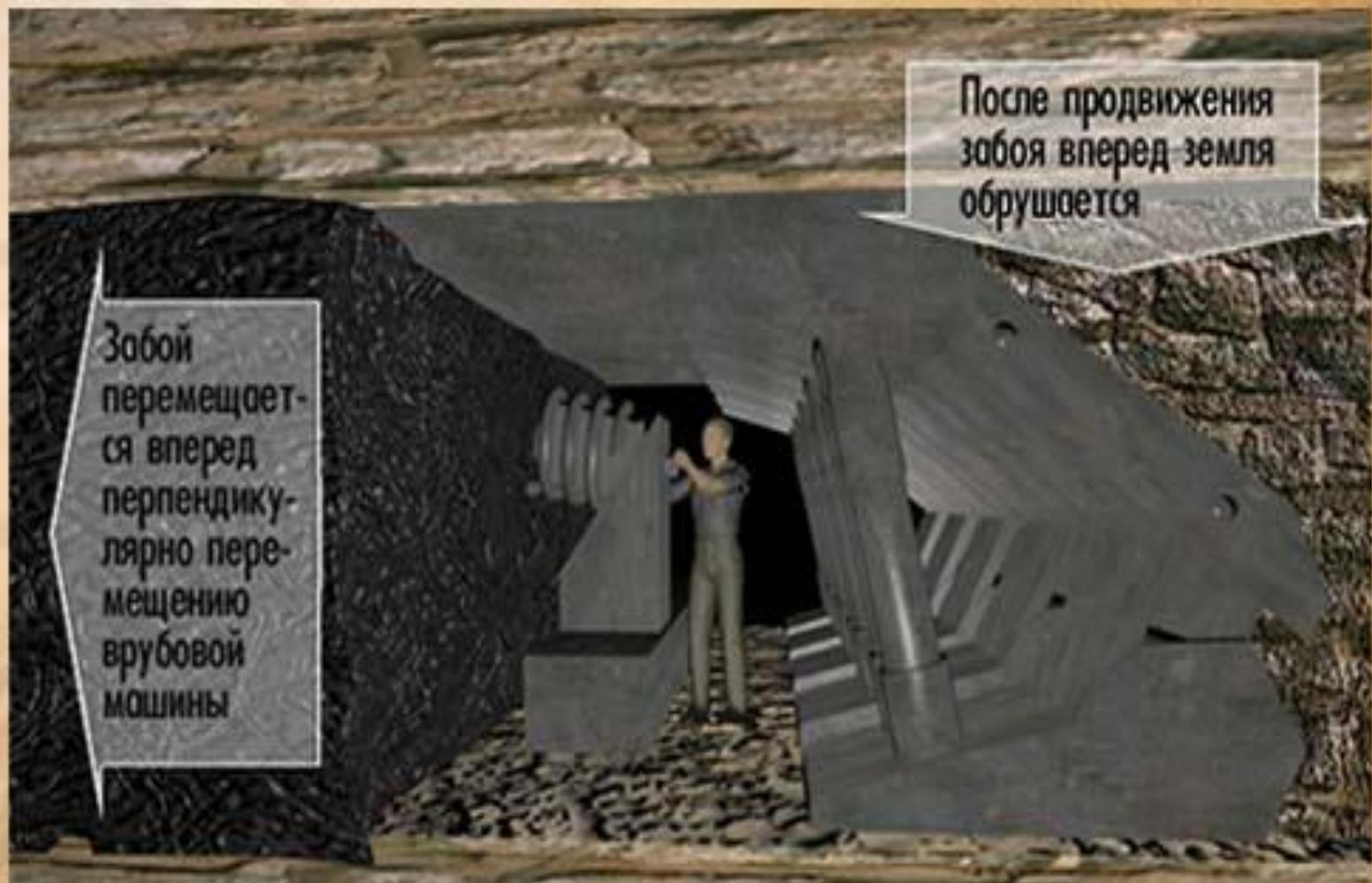
Схема механизированного забоя. Врубовая машина срезает угольный пласт вдоль забоя, увеличивая тем самым его ширину. По мере расширения забоя механическая кровля перемещается вперед, перекрывая забой сверху и препятствуя обрушению породы за стояками.
