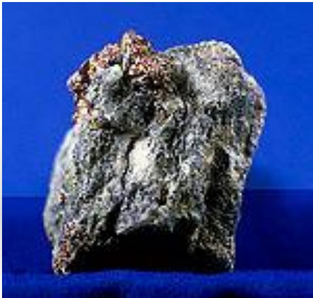
**Медь** — это пластичный металл золотисто-розового цвета. Один из первых металлов, широко освоенных человеком из-за сравнительной доступности для получения из руды и малой температуры плавления. Медь в древности применялась в основном в виде сплава с оловом — бронзы Для изготовления оружия . Большая часть медной руды добывается открытым способом. Содержание меди в руде составляет от 0,4 до 1,0 %.
