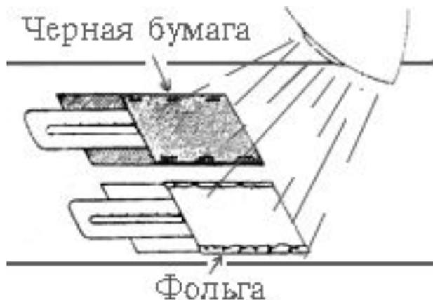
*Взяли* черную бумагу, два уличных термометра, стиплер, алюминиевую фольгу, 100-ваттную лампу
