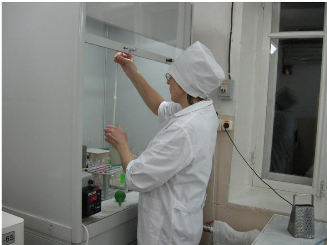
Для определения жирности молока необходимо оборудование и реактивы. Для определения жирности молока, его подогревают до температуры  $20^{\circ}$ , помещают в жиромер. Исследования проводят в вытяжном шкафу, так как из реактивов требуется изоамиловый спирт (1мл), органическое вещество с неприятным запахом, серная кислота  $\rho=1,81 \text{ г/см}^3$ . Для отделения жира необходима центрифуга. Содержание жира в пробе исследуемого молока оказалось равным 4%.
