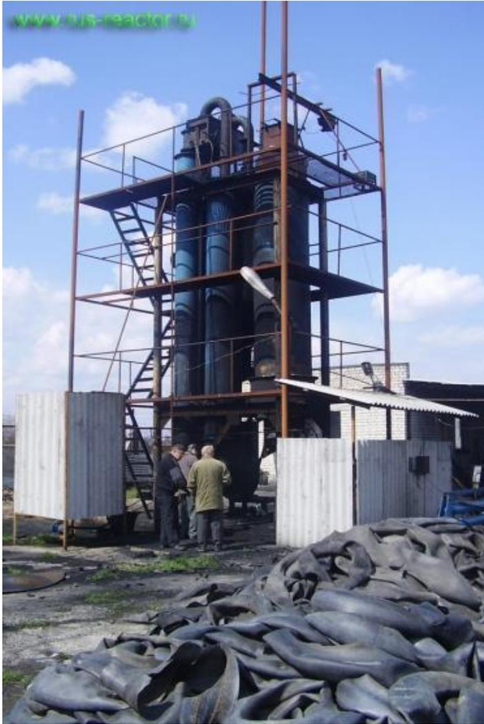
В ходе экспериментального запуска "Русского реактора" было уничтожено 80 тонн бывших в употреблении автошин. В «сухом осадке» оказалось 10 тонн искусственной нефти, которая после элементарной перегонки превратилась в первоклассное дизельное топливо, а также - 40 тонн высокодисперсной сажи, очень необходимой для производства красителей. Этот результат специалисты без натяжек назвали ошеломляющим.
