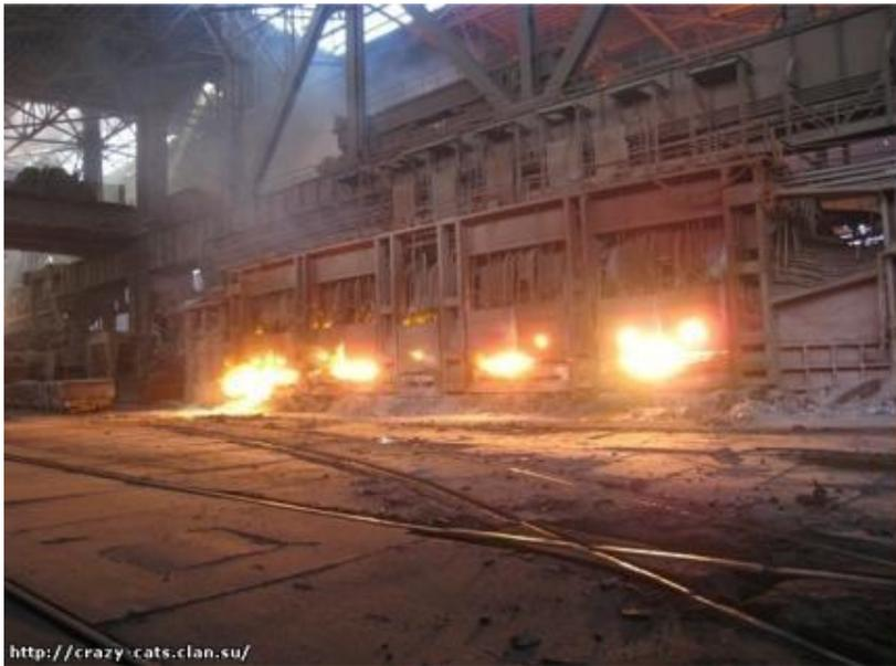
У мартеновских печей теплота продуктов сгорания равна 12,5 ГДж/т стали, у нагревательных печей 0,8 ГДж/т проката. Использование этой теплоты возможно в котлах-утилизаторах при условии оснащения их виброочисткой, дробеочисткой. Возможно использование этой теплоты для нагрева шахты в шахтных подогревателях.
