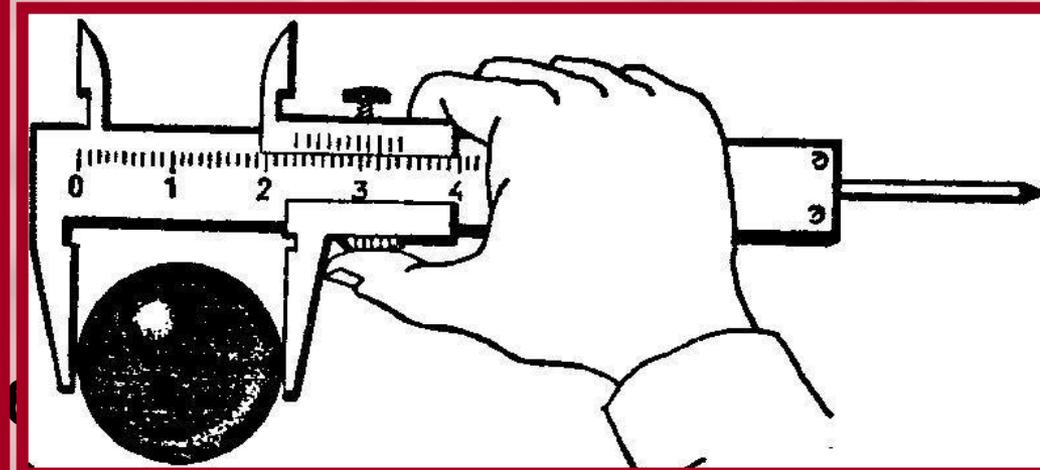
Измеряют диаметры шаров **кронциркулем** или **штангенциркулем**. А если требуется большая точность – **микрометром**.
