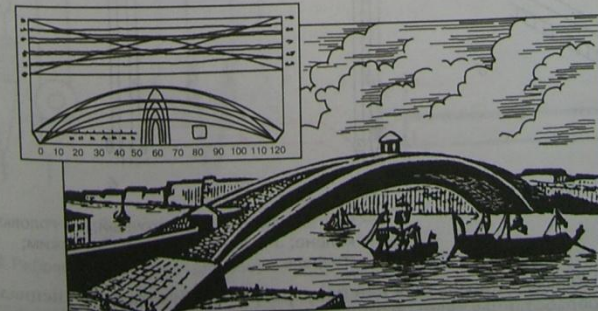
Рис. 13. Проект одноарочного моста через Неву (1776)
