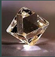
Монокристалл алюминио-калиевых квасцов имеет форму октаэдра.
