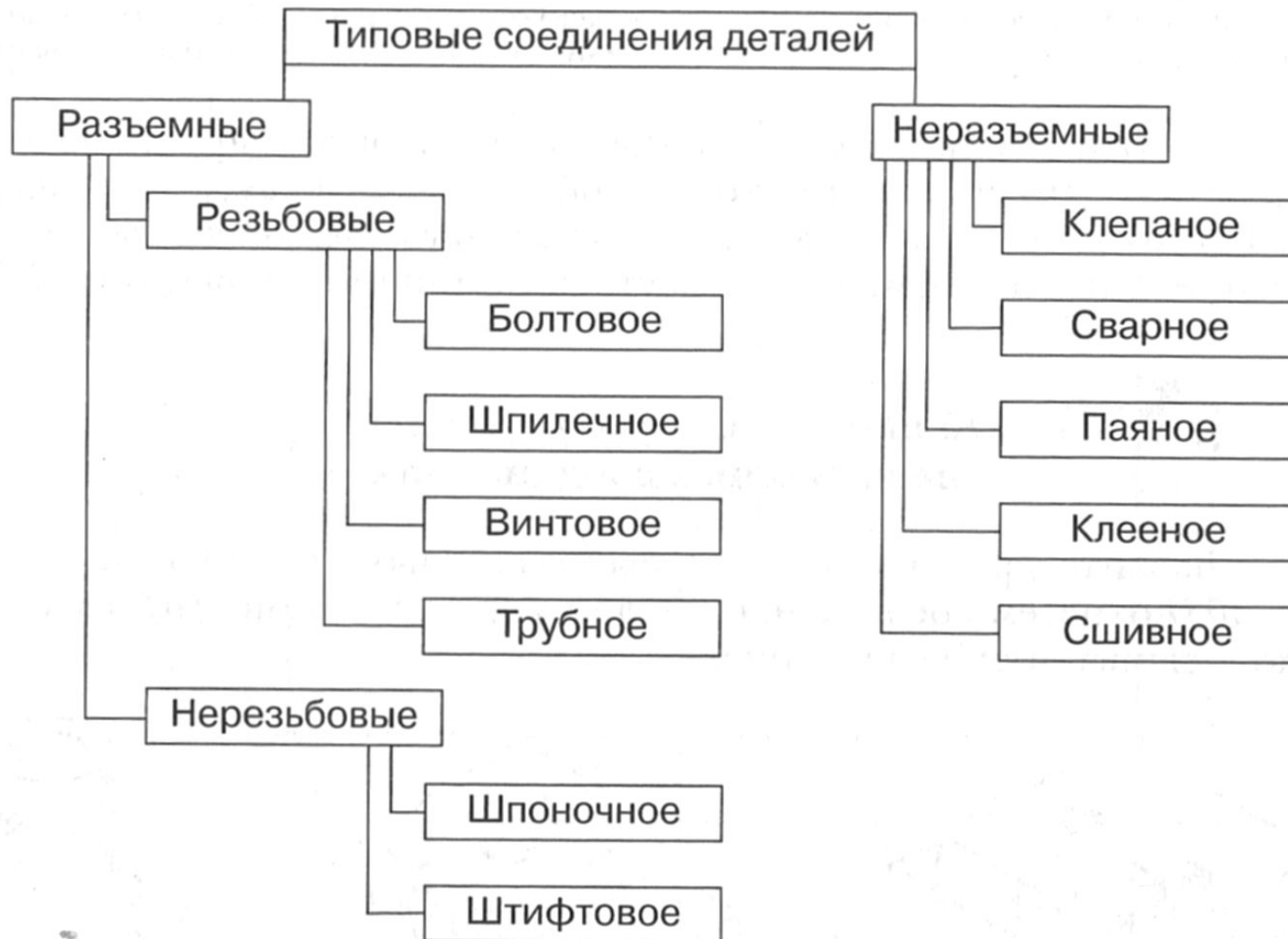
Рис. 305. Классификация типовых соединений деталей
