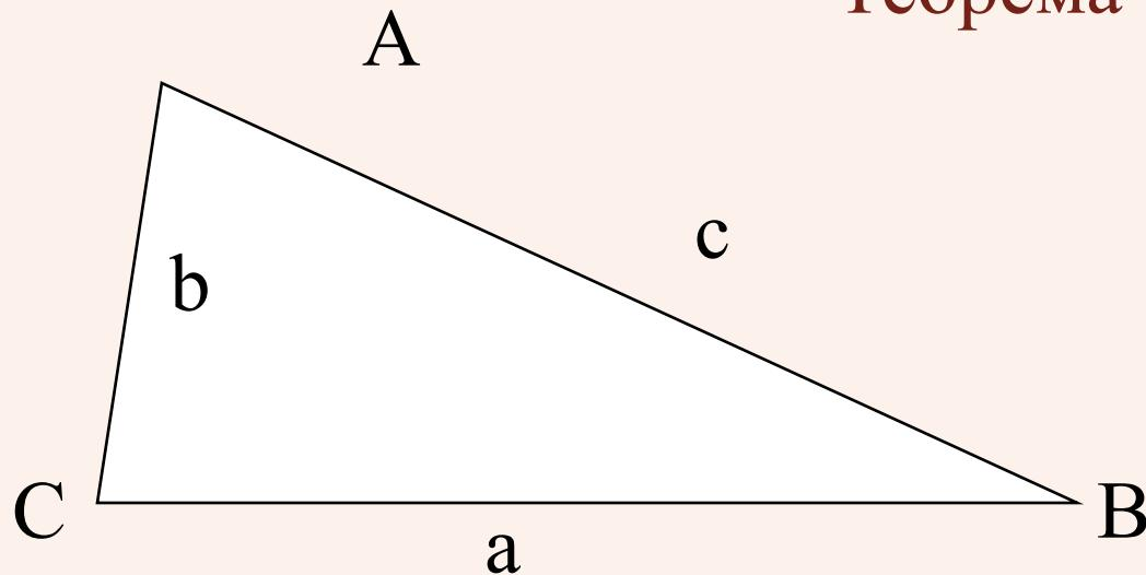
Стороны треугольника пропорциональны синусам противолежащих углов
