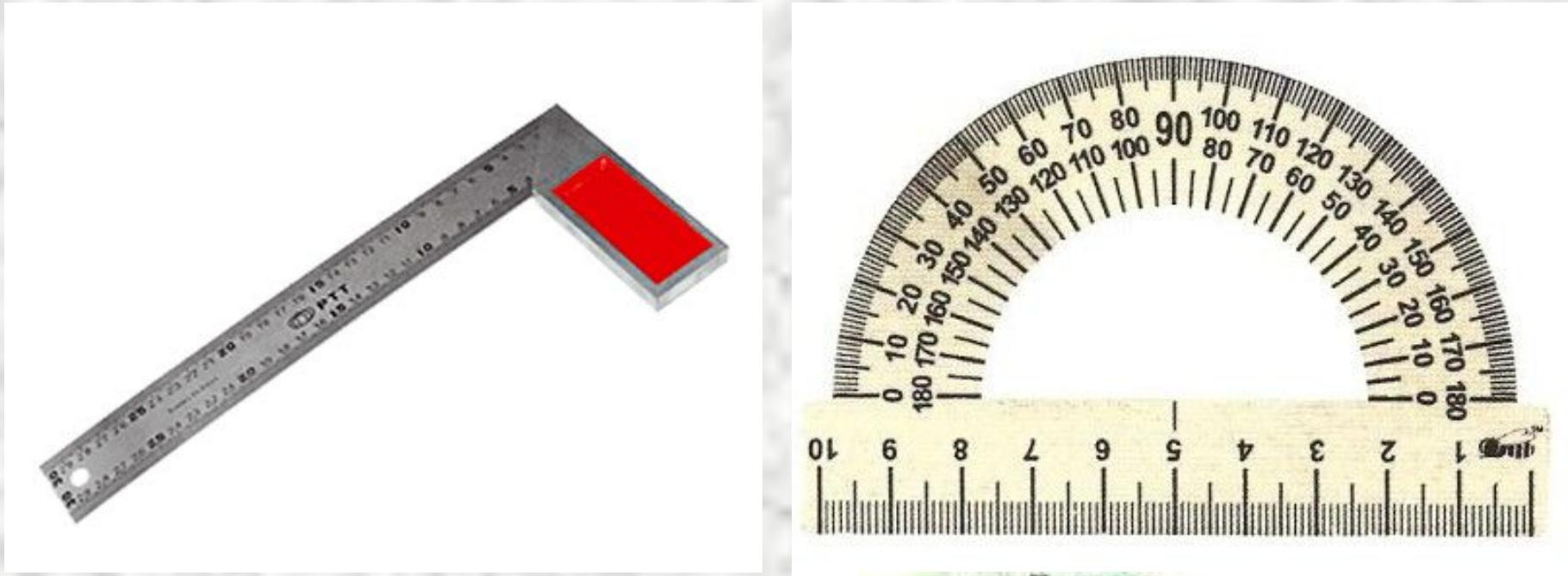
Предназначен для разметки и проверки прямых углов, а также для проверки угла 45 градусов при обработке и сборке изделий.
