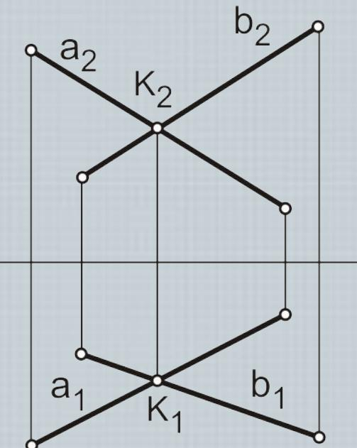
**Графический признак:**  $(a \cap b = K) \Rightarrow (a_i \cap b_i = K_i), (a_j \cap b_j = K_j)$ ,
