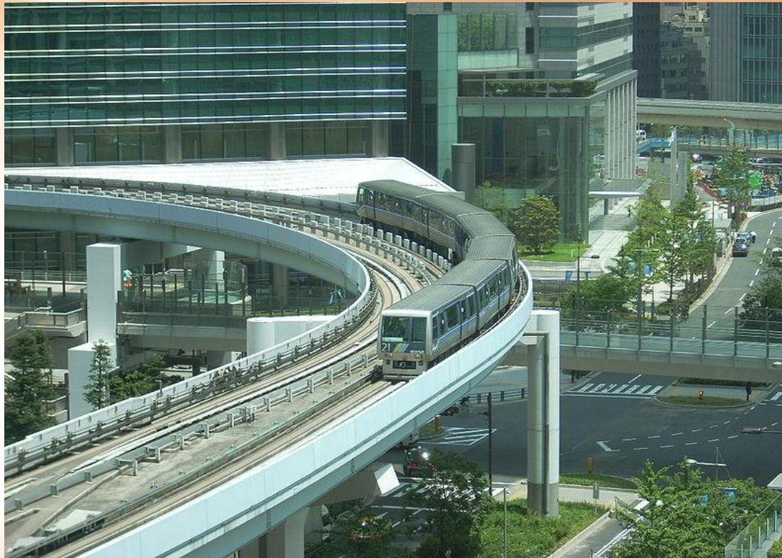
Это целый класс систем направленных на автоматизированное перемещение пассажиров по заданному маршруту. К ним относятся и отдельные монорельсы, рельсовые системы, шинный транспорт, приводимые магнитно или оптически системы, примененные в условиях небольших пассажиропотоков не имеющих четких пиков. Ну вот например между терминалами аэропорта.
