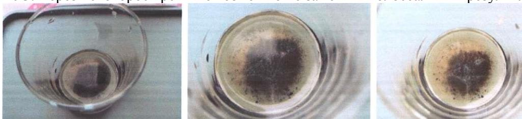
Наблюдение: при добавлении к мультифруктовому соку активированного угля яркий и насыщенный оранжевый цвет меняется на обесцвеченную жидкость с углем, выпавшим в осадок. Раствор изменил свою температуру.
