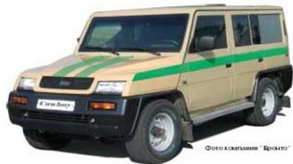
Защитное остекление В2 класса
