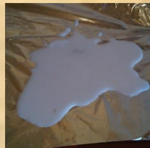
Воду слили, осадок поместили на фольгу и сушили в теплом месте в течение 12 часов
