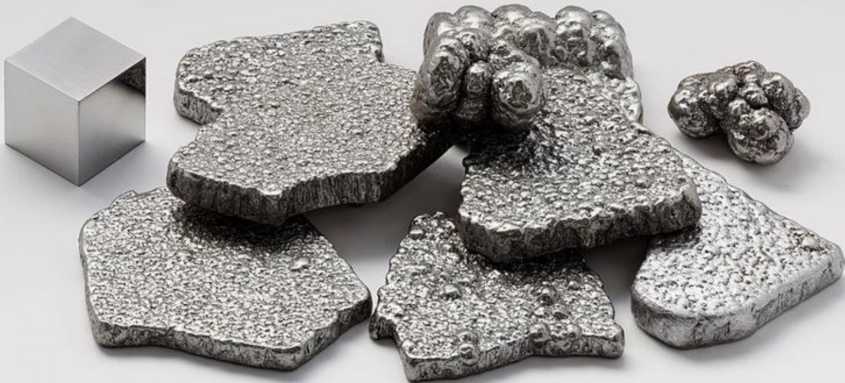
Железо. Куски железа, очищенного электролизом. Для сравнения слева помещен кубик из высокочистого (99,9999%) железа (сторона - 1 см)
