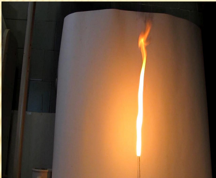
Горение ацетилена на воздухе копящим пламенем
