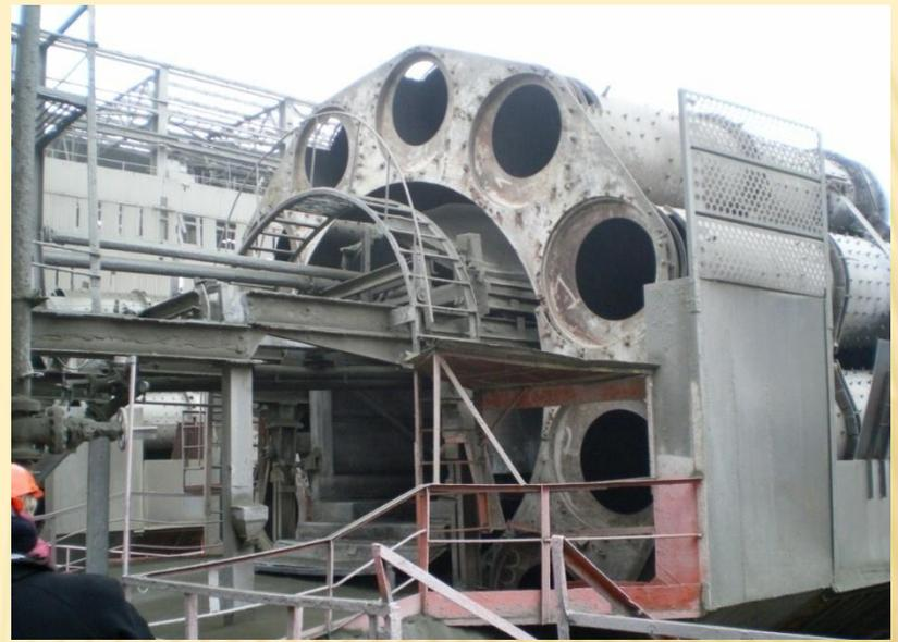
В зоне экзотермических реакций ( $1200 - 1350\text{ }^{\circ}\text{C}$ ) осуществляется образование минералов: основных количеств  $\text{C}_4\text{AF}$  и  $\text{C}_2\text{S}$ , завершается процесс твердофазового спекания материала. Материал агрегируется в гранулы размером  $2 - 10\text{ мм}$ , окраска материала изменяется из светло-коричневого в светло-серую вследствие связывания  $\text{Fe}_2\text{O}_3$  в соединения.
