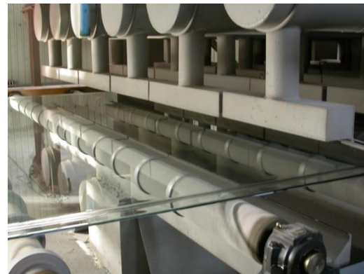
Схема изготовления листового полированного стекла непрерывным прокатом.
