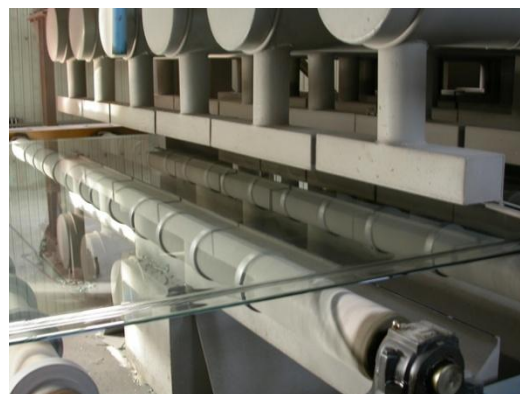
Схема изготовления листового полированного стекла непрерывным прокатом.
