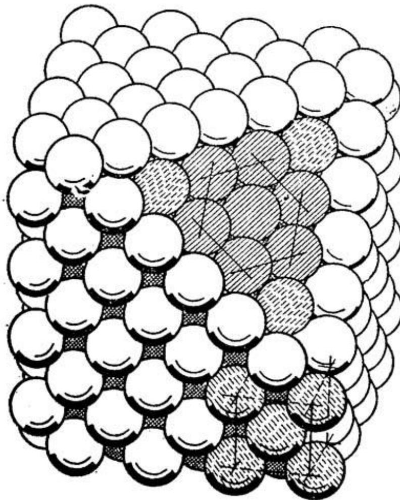
Вместе с тем и электроны удерживаются ионами в пределах кристаллической решетки и не могут ее покинуть. Большинство металлов имеет кристаллические решетки одного из трех типов: кубическую объемно-центрированную, кубическую гранецентрированную и, так называемую, плотную гексагональную.
