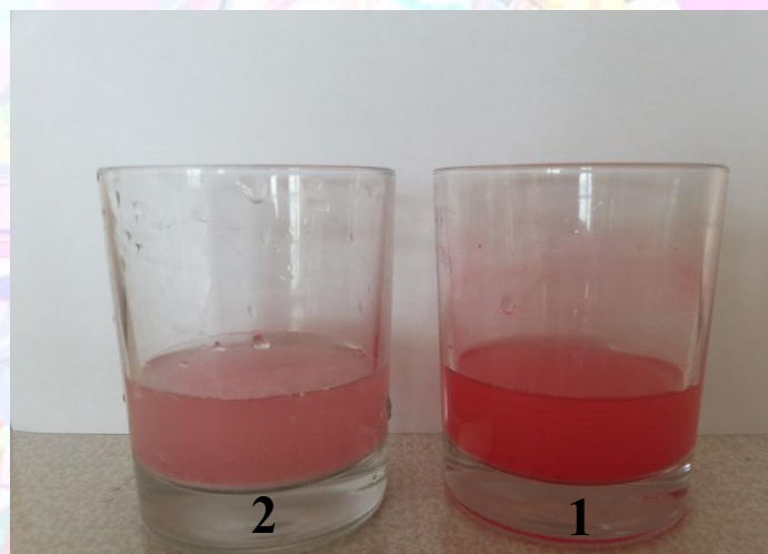
1- контрольный образец ацетата свинца 2- ацетат свинца с вайтсорбом
