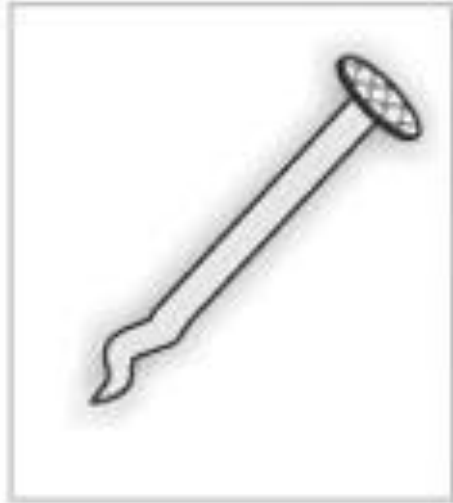
Изменение формы гвоздя при ударе молотком
