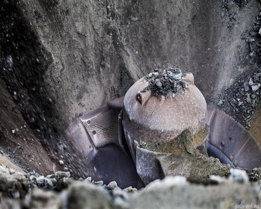
Гирационная дробилка состоит из двух конусов, между которыми происходит дробление продукта. Неподвижный конус имеет внутреннюю рабочую поверхность, облицованную плитами из износостойкой стали.
