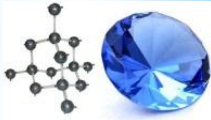
Прозрачные кристаллы; после обработки - бриллианты. Добывают из россыпей и коренных месторождений. Синтетический алмаз получают из графита при высоком давлении и температуре.
