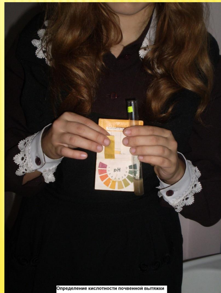
Определение кислотности почвенной вытяжки
