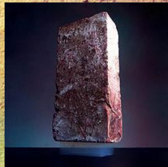
Кирпич массой 2,5 кг стоит на куске аэрогеля массой 2,38 г
