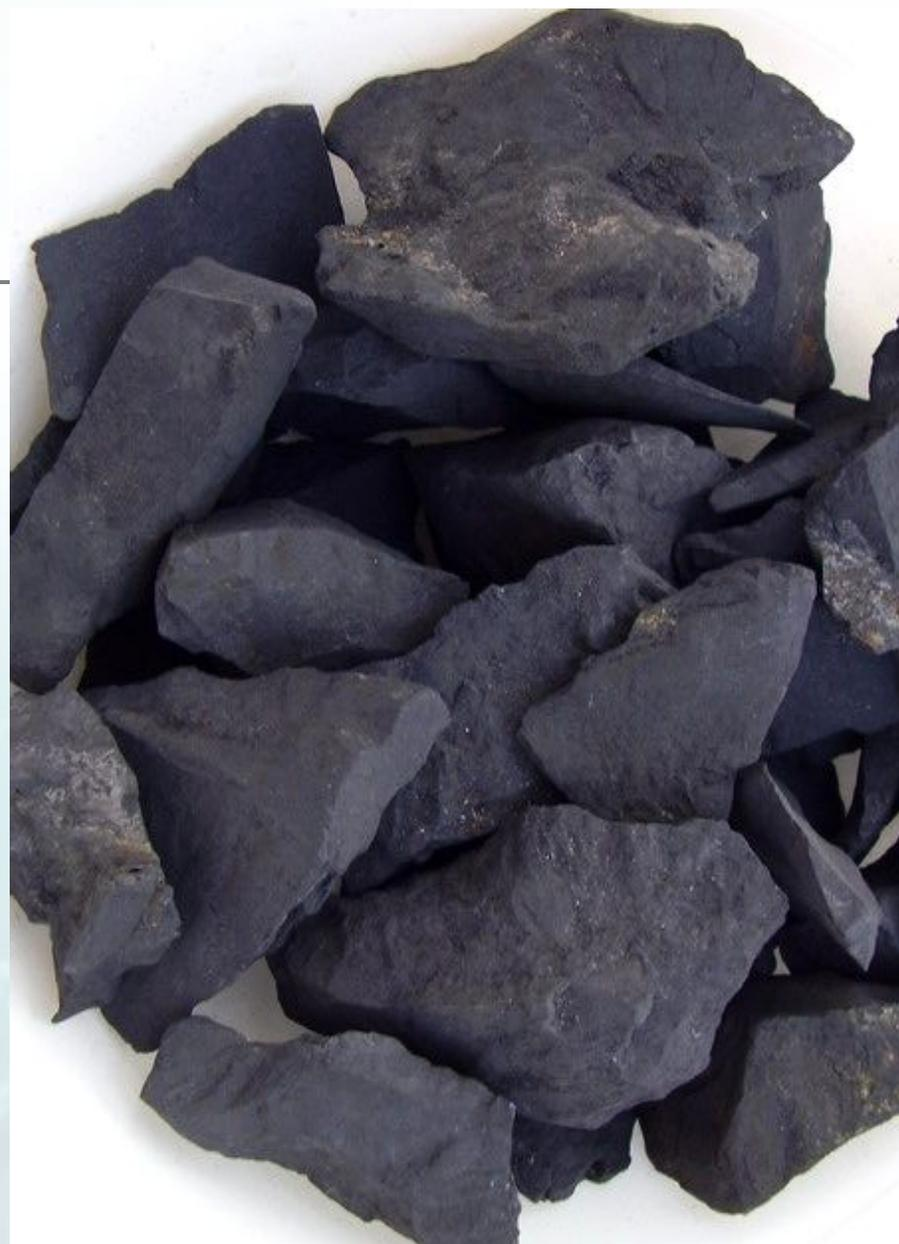
**Гипотеза:** в отличие от искусственных фильтров природный шунгит способен длительное время сохранять бактерицидную, сорбционную, каталитическую активность, поэтому является отличным материалом для очистки водопроводной воды.
