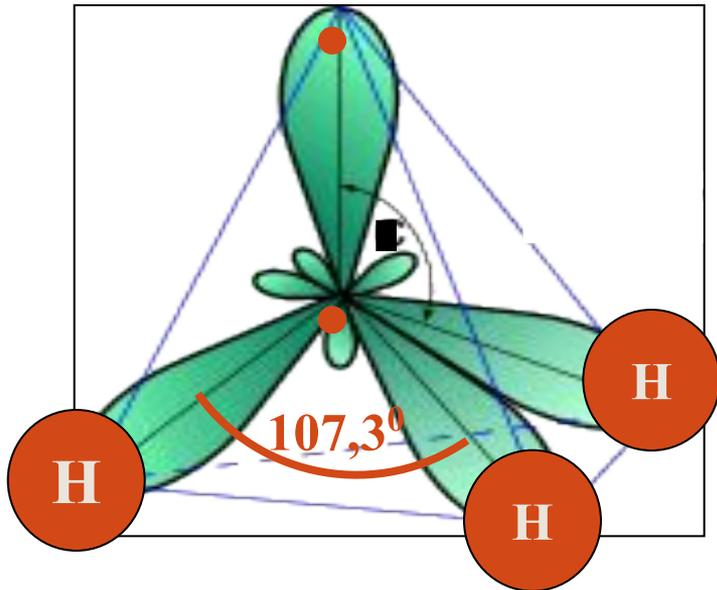
На 4-й гибридной орбитали атома N находится неподеленная пара электронов.
