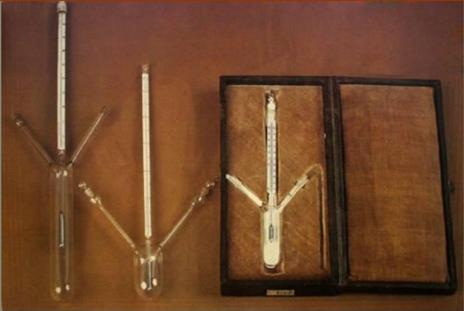
Пикнометр конструкции Д.И. Менделеева
