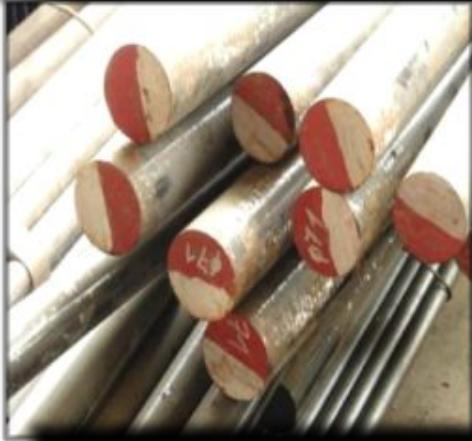
**Нихром** — общее название группы сплавов, состоящих, в зависимости от марки сплава, из 55—78 % никеля, 15—23 % хрома, с добавками марганца, кремния, железа, алюминия.
