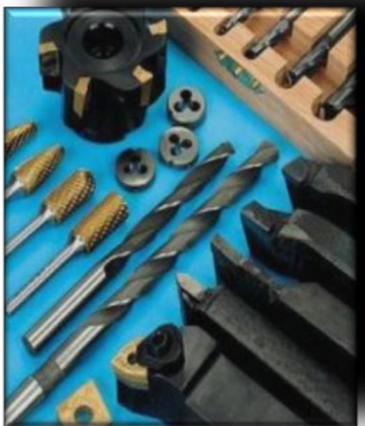
**Победит** — металлокерамический твердый сплав. Твёрдый сплав карбида вольфрама WC и кобальта в соотношении 90% и 10% масс, соответственно. Он по твердости близок к алмазу, применяется при бурении горных пород.
