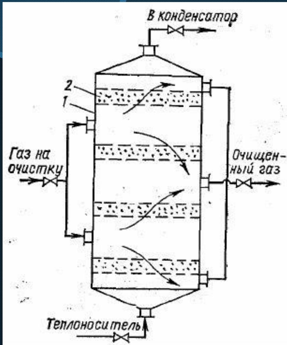
Рис. 1. Адсорбер полочного типа с неподвижными слоями адсорбента
