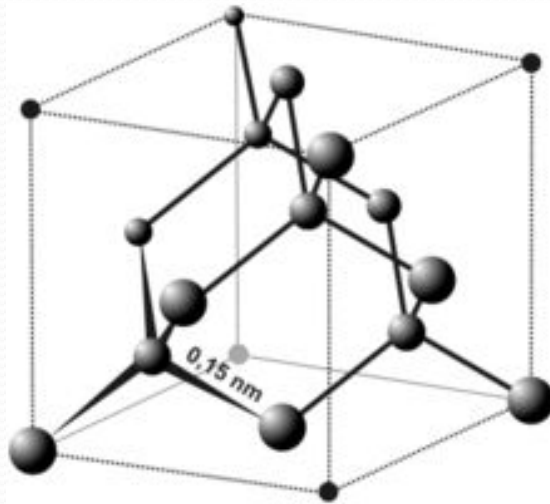
Элементарная ячейка алмаза
