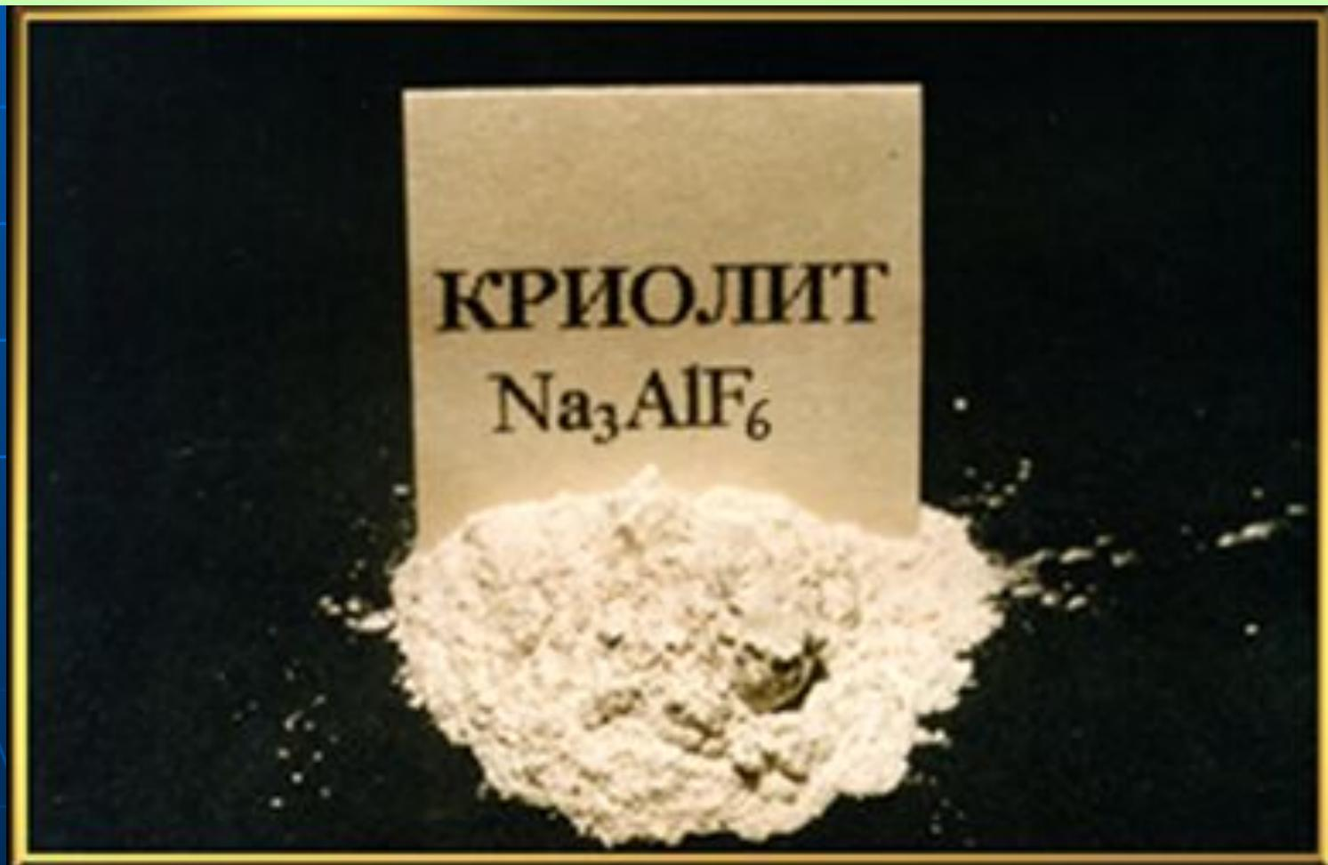
Криолит ( $\text{Na}_3\text{AlF}_6$  гексафторалюминат натрия) оказался наиболее подходящим растворителем для  $\text{Al}_2\text{O}_3$ . Он плавится при  $1000^\circ\text{C}$ , в нем растворяется 8-10% оксида алюминия. Для снижения температуры плавления электролита обычно в него добавляют до 8-10% смеси фторидов  $\text{Al}$ ,  $\text{Ca}$  и  $\text{Mg}$ , что позволяет вести электролиз при  $950$ - $970^\circ\text{C}$ .
