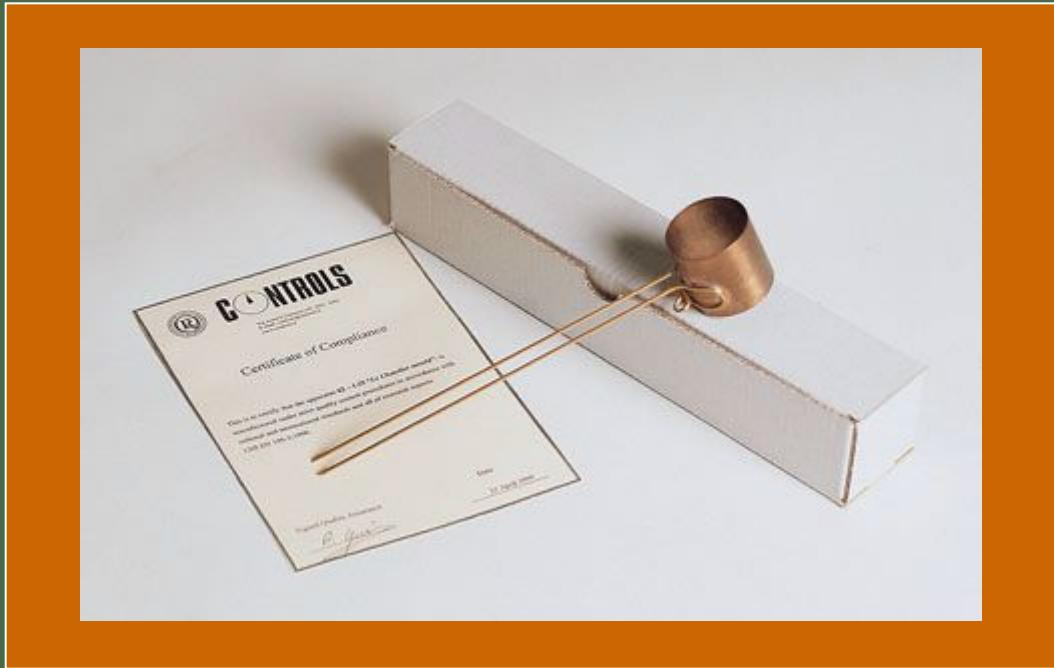
Для определения равномерности изменения объема цемента и гашеной извести.
