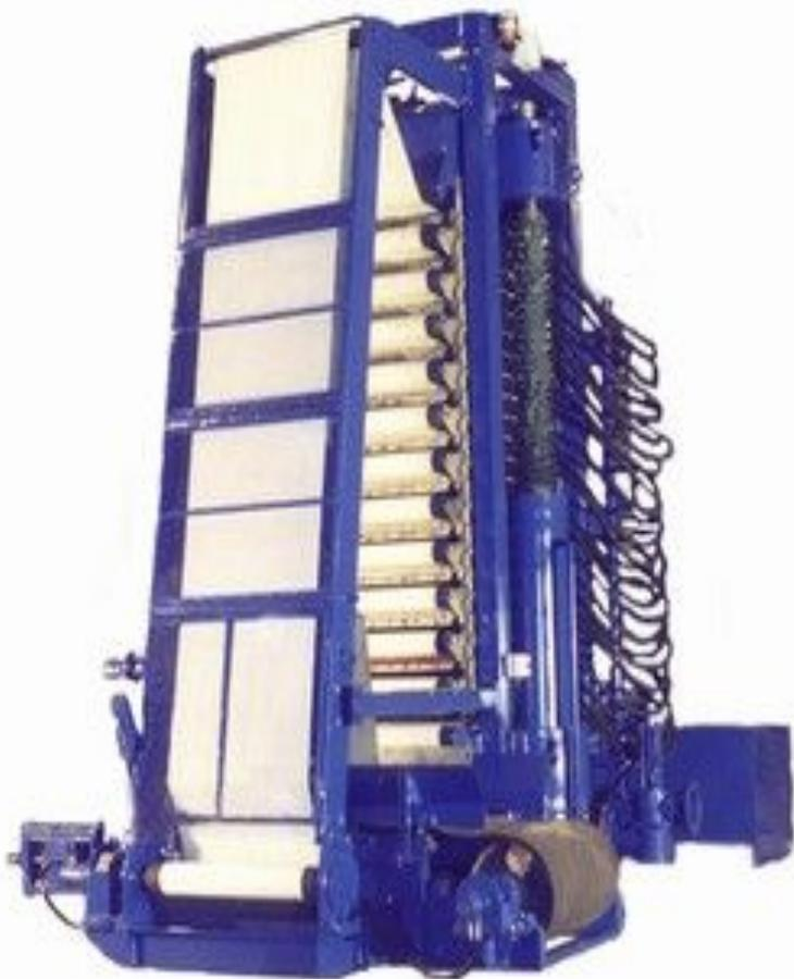
Фильтрация используется для тонкого разделения жидких или газовых гетерогенных систем. С его помощью можно добиться значительно более полной, чем в процессах осаждения, очистки жидкости или газа от взвешенных частиц и, соответственно, более высокого выхода продукта (если им является твердая фаза суспензии).
