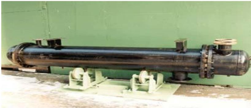
Кожухотрубные теплообменники имеют большую поверхность теплообмена при относительно небольших размерах.
