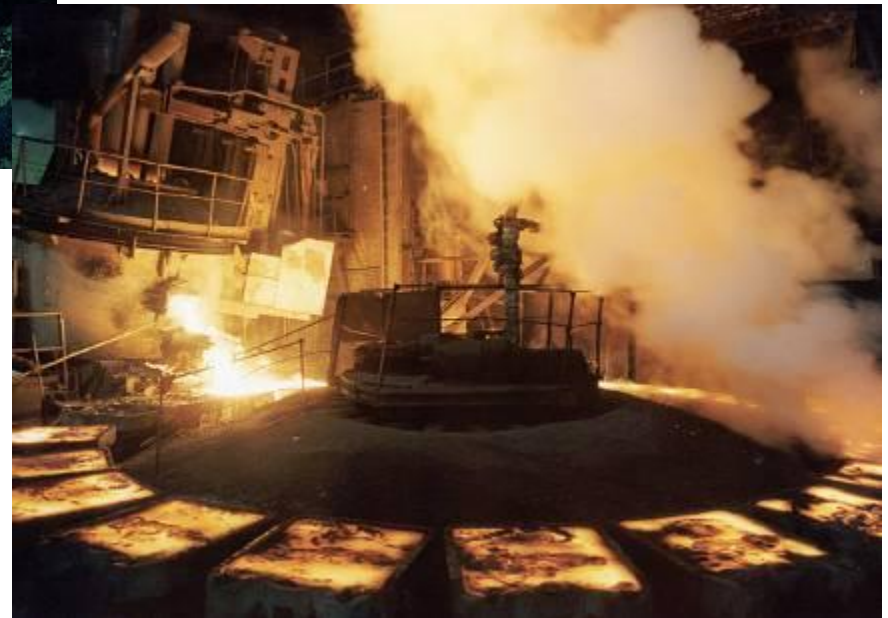
Никелевый завод. Разлив никелевых анодов.
