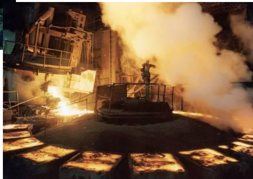
Никелевый завод. Разлив никелевых анодов.
