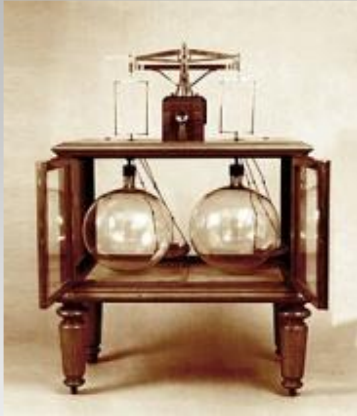
Весы, сконструированные Д. И. Менделеевым для взвешивания газообразных и твёрдых веществ
