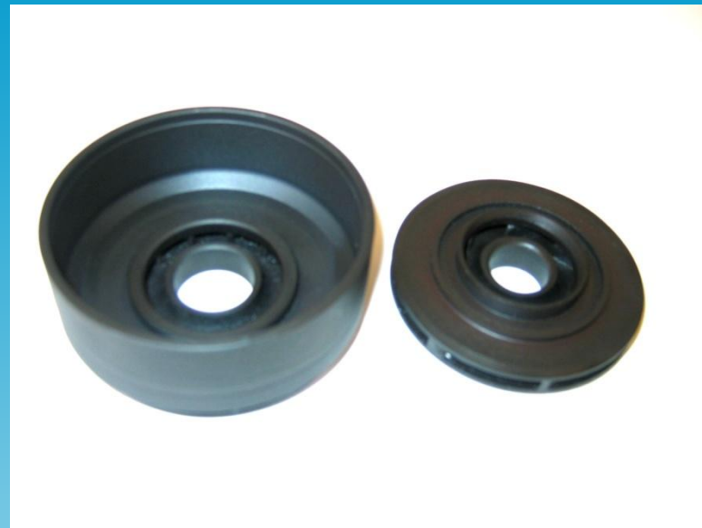
Н.аппарат НМ 003.016, ц/б, после азотирования.
