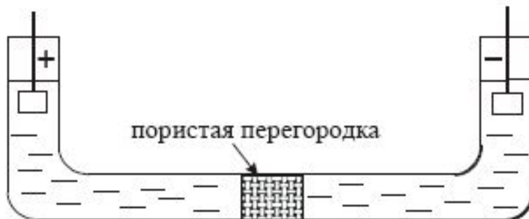
Рис. 4.38. Схема установки для изучения электромиграции ионов актиноидов
