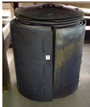
Компоненты теплового узла: 1 — нагревательный элемент, 2 — блок экранов, 3 — токоввод (левый)
