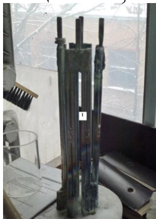
Компоненты теплового узла: 1 — нагревательный элемент, 2 — блок экранов, 3 — токоввод (левый)
