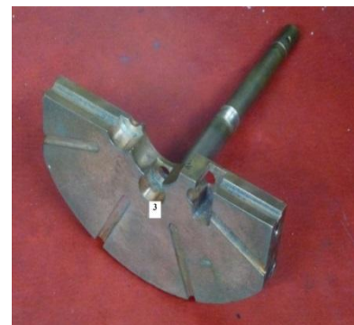
Компоненты теплового узла: 1 — нагревательный элемент, 2 — блок экранов, 3 — токоввод (левый)
