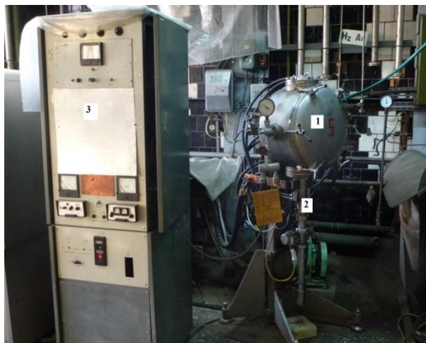
Установка «Гранат-2»: 1 — кристаллизационная камера, 2 — механизм перемещения контейнера с веществом, 3 — блок управления
